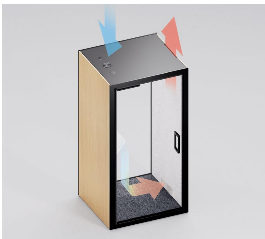
Mini est équipé d'un système de recyclage de l'air et d'un système d'éclairage à bande de leds, intégrés dans le plafond. Un détecteur de présence au plafond permet l'activation des deux systèmes, dont l'extinction automatique est prévue après 320 secondes d'inactivité. Sous l'étagère murale, MINI abrite également une multiprise pour l'alimentation d'appareils électriques.
